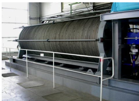
Рис. 9 Электролизер компании NORSK, Норвегия производительностью 125 м 3 /ч водорода с чистотой 99,5 % при давлении 1,0 МПа.
