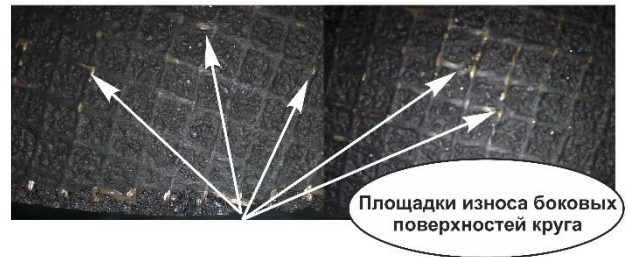
Рис. 2. Образование площадок износа отрезного круга
