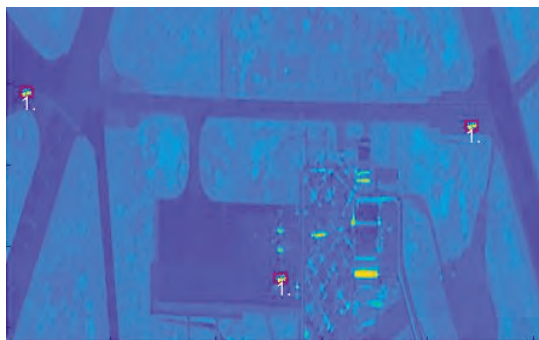
Рис. 1. Распознавание объекта в виде грузового автомобиля ЗИЛ на радиолокационном изображении
