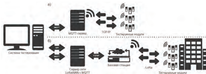
Рис. 1. Схема взаимодействия между системой тестирования и тестируемыми модулями с поддержкой стека TCP/IP; б) тестируемыми модулями LoRaWAN
