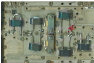
Рис. 2. Конструкция выходного каскада усилителя
