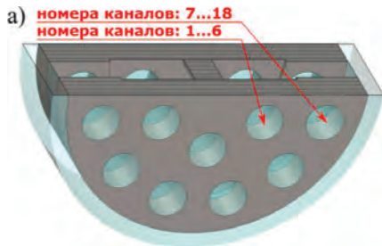
Рис. 1. (а) сечение многолучевого резонатора; (б) эффективное характеристическое сопротивление \rho M^2 (Ом) на оси всех пролётных каналов резонатора
