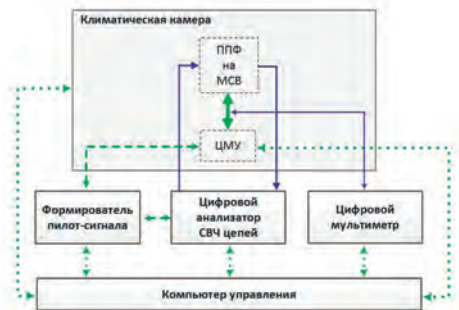
Рис. 2. Структурная схема стенда для калибровки ППФ на МСВ
