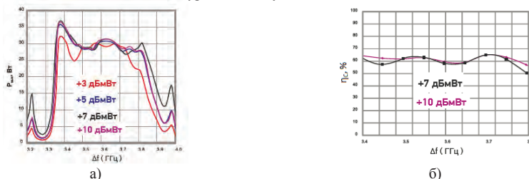
Рис. 1. Выходная мощность усилителя мощности и КПД в непрерывном режиме
