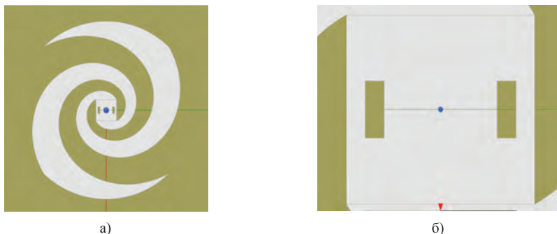
Рис. 1. Компенсация емкости щели на входе антенне с помощью индуктивных окон. а) Логарифмическая спиральная антенна со скомпенсированной щелью на входе. б) Щель 50 мкм длины и 100 нм ширины, на концах которой – два компенсирующих индуктивных окна
