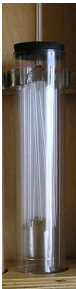
Рисунок 3.2 – Поглотительный сосуд: 1 – стакан; 2 – колокол; 3 – колпачок; 4 – тонкостенные стеклянные трубки (45 шт.); 5 – пробка; 6 – трубка; 7 – силиконовая трубка
