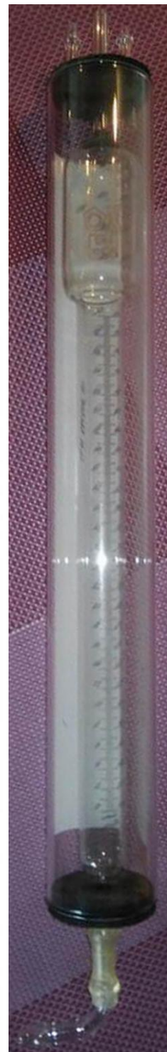
Рисунок 3.3 – Измерительная бюретка: 1 – бюретка; 2 – цилиндр; 3, 7 – пробка; 4 – стеклянные трубки; 5 – отвод; 6 – силиконовая трубка
