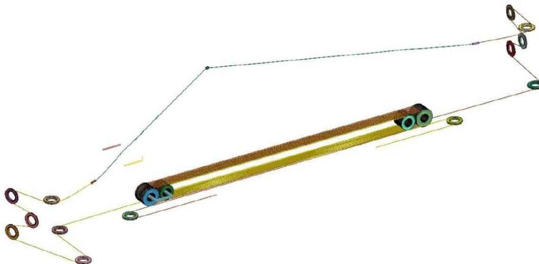
Моделирование динамических процессов, возникающих при посадке истребителя на палубу авианосца [6,7].
