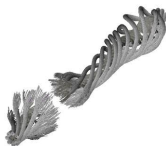
Моделирование разрыва троса аэрофинишера [6,7].
