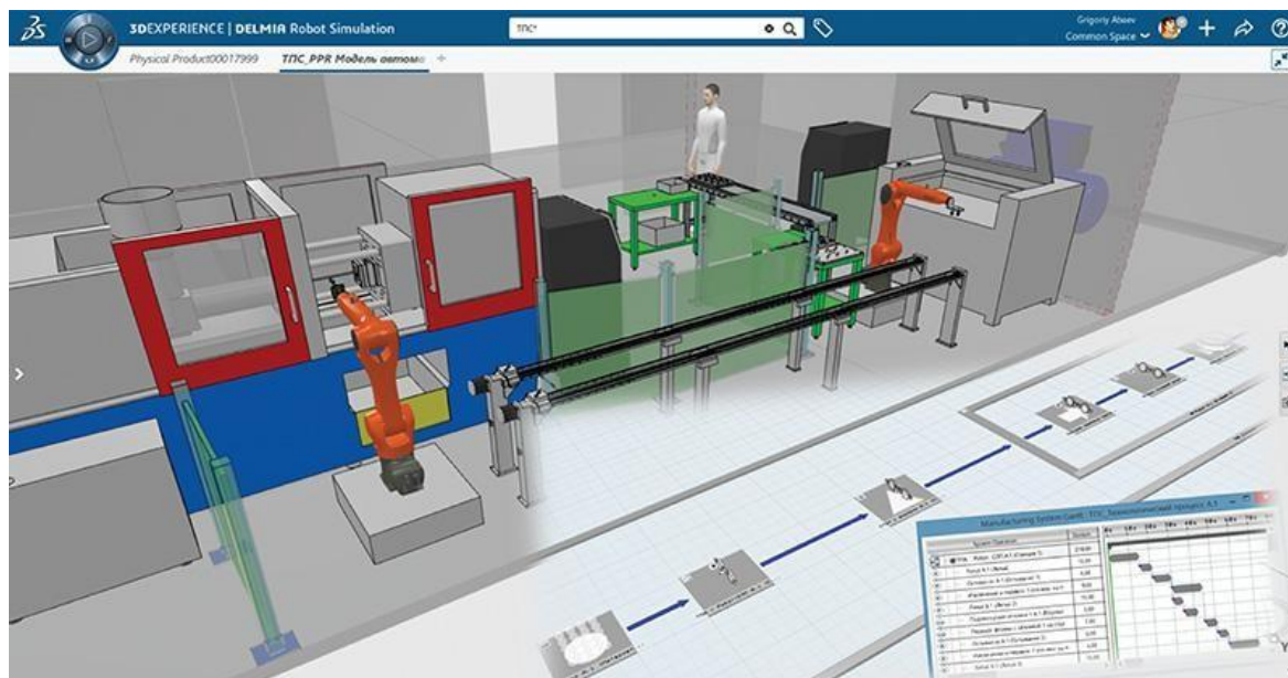
Рис. 4. Модель производственной ячейки и технологического процесса, представленная с помощью диаграммы Ганта (как показано в DELMIA 3DEXPERIENCE) [12, 13]
