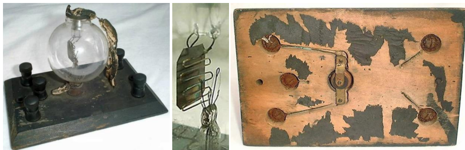
Рис. 8. Набор для самостоятельной сборки аудиона компании Electro Importing Co. 1911 г.
