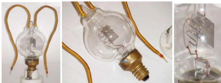
Рис. 2. Аудион сферической формы с одной нитью накала. 1908 г.
