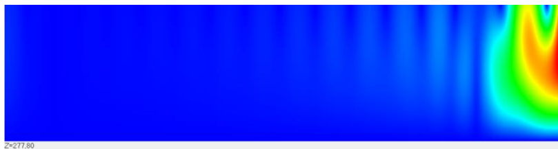
Рис. 9. Распределение модуля напряженности электромагнитного поля в продольном сечении волновода.
