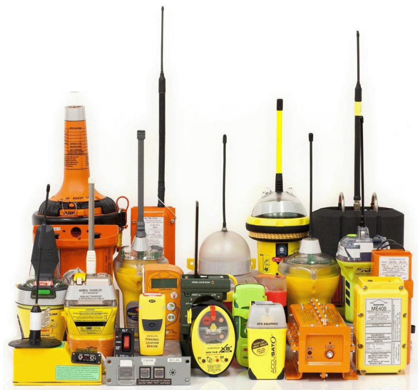
Рисунок 4.3 — Радиобуи системы КОСПАС—SARSAT
