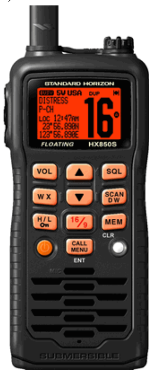
Рисунок 13.13 — Внешний вид ОВЧ ЦИВ GPS портативной радиостанции HX851 (а) и стационарной радиостанции ОВЧ типа GX1700 с встроенными GPS и DSC (Class D) фирмы Standard Horizon
