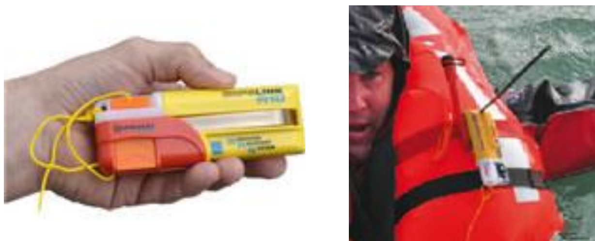
Рисунок 13.8 — Установка персонального бую АИС Smartfind модели S20 на спасательном жилете
