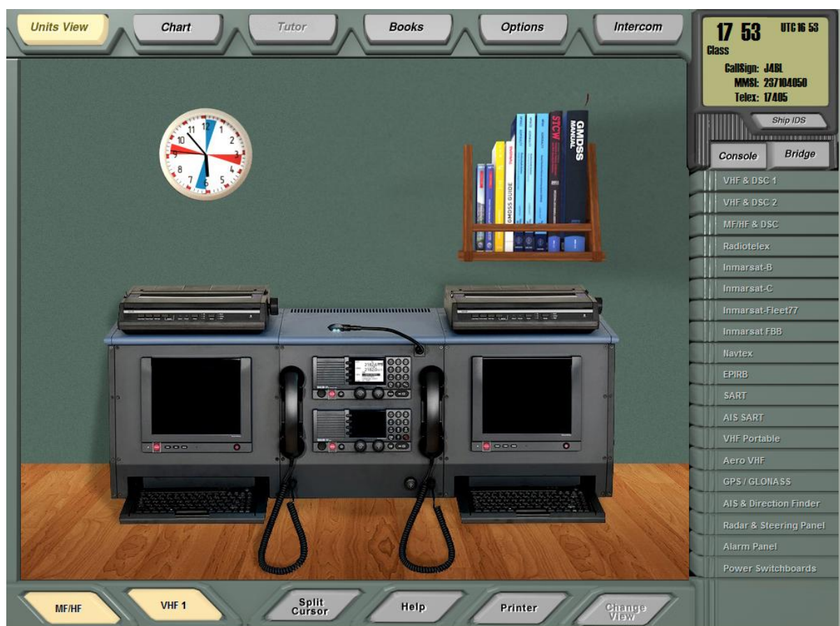
Рисунок 11.2 — Консоль ГМССБ судна (тренажер ГМССБ TGS-6000)
