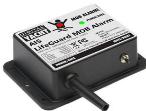
Рисунок 13.9 — Внешний вид приемника-индикатора тревоги для персональных буюв АИС
