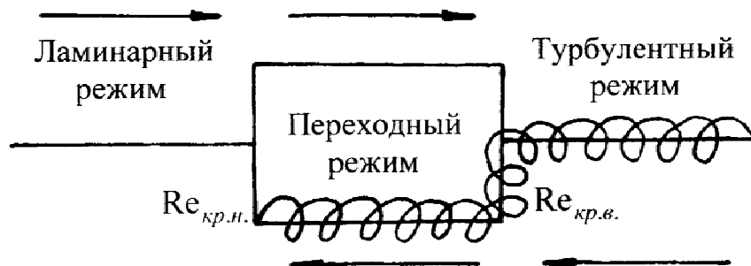
Рисунок 2.4 – Переход из ламинарного режима в турбулентный и обратно
