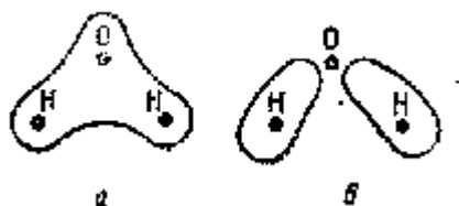
Рис. 4.16 Схема распределения электронной плотности в молекуле H 2 O: а — при описании молекулы трехцентровыми МО; б — при описании молекулы двухцентровыми ЛМО
