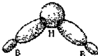
Рис. 3.21. Формирование двухэлектронной трехцентральной связи B-H-B
