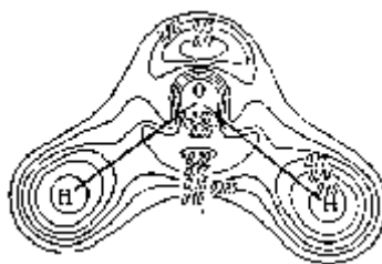
Рис. 1.1. Распределение электронной плотности в молекуле воды
