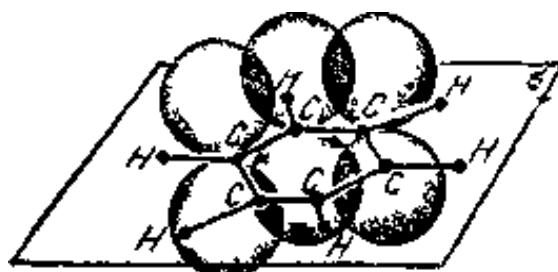
Рис. 4.20. Схема молекулы C_6H_6 . Показаны 2p_z -АО трех атомов С ( p_a, p_b, p_c )
