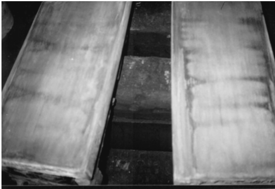
Рисунок 2 – Узкие стенки кристаллизатора R-7 после его разборки
