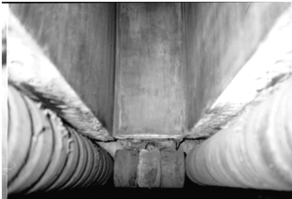
Рисунок 1 – Кристаллизатор R-7 после снятия с МНЛЗ на стенде
