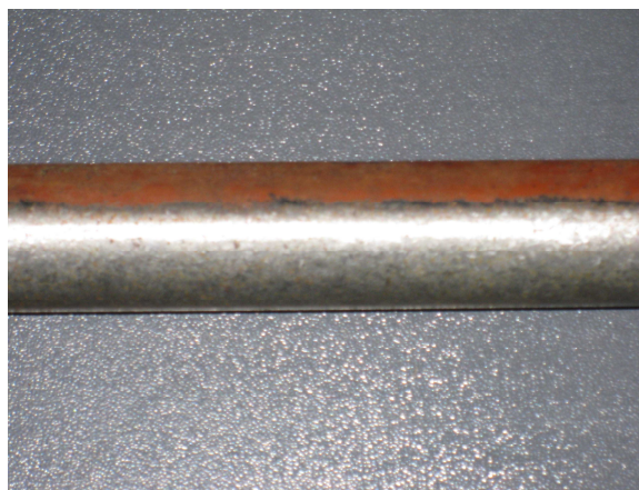
Рисунок 1 – Нерівномірна обробка деталі
