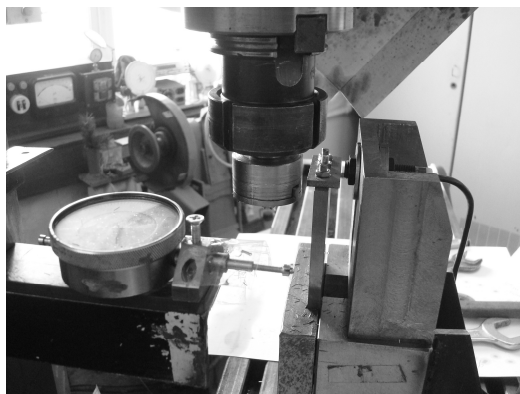
Рисунок 1 – Стенд для исследования механических колебаний при фрезеровании тонкостенных деталей и его принципиальная схема:
