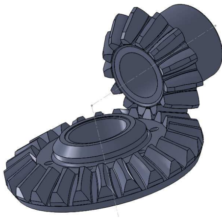
Рисунок 1 – Исследуемая коническая передача с ДВВ-зубьями
