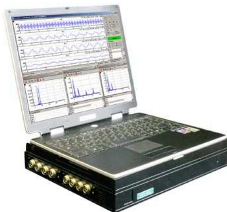
Рисунок 5 – Портативный цифровой анализатор-регистратор динамических процессов MIG-200
