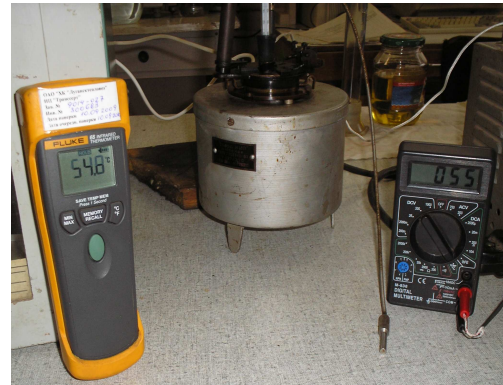
Рисунок 4 – Общий вид тигля дооснащенного термопарами и приборами для фиксации температур (Fluke655)
