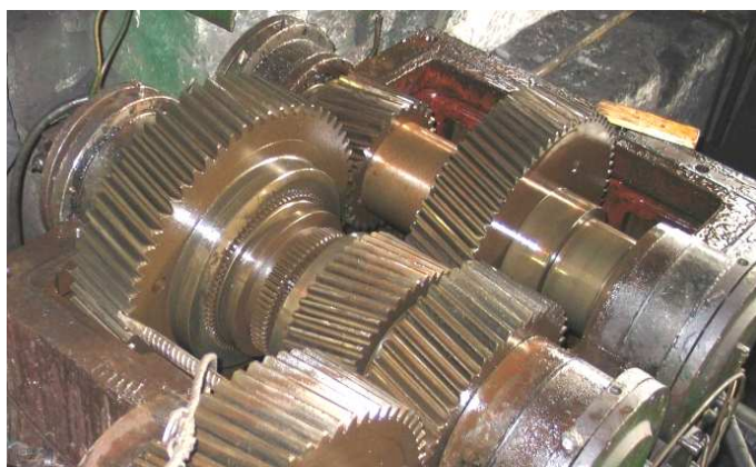
Рисунок 1 – Общий вид привода бесцентрового токарного станка
