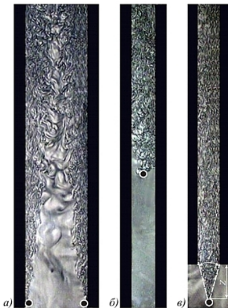
Рисунок 3 – Различные варианты течения плоской газожидкостной струи, ограниченной двумя вертикальными поверхностями теплообмена
