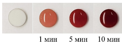
Рисунок 4. Динамика образования цветного продукта реакции окислительного азосочетания при использовании композита для визуального качественного обнаружения фенола в образце воды
