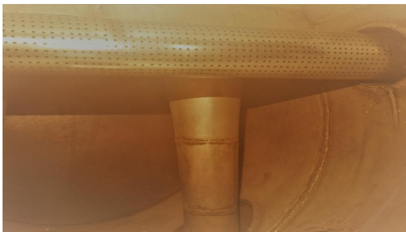
Рис. 3. Разбрызгивающее устройство в испарителе
