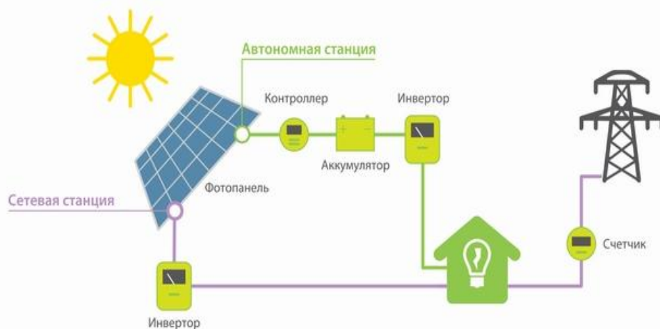
Рис. 1. Схема работы солнечной электростанции
