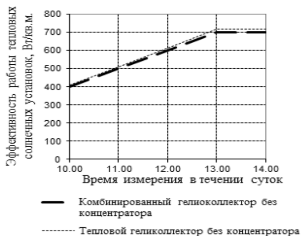
Рис. 6. Сравнительная мощностная тепловая выработка солнечных установок
