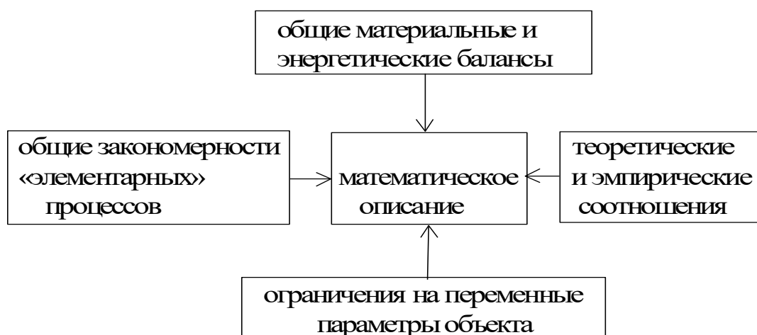
Рис. 2.1. Логическая схема построения математической модели химико-технологического процесса на основе физического описания объекта
