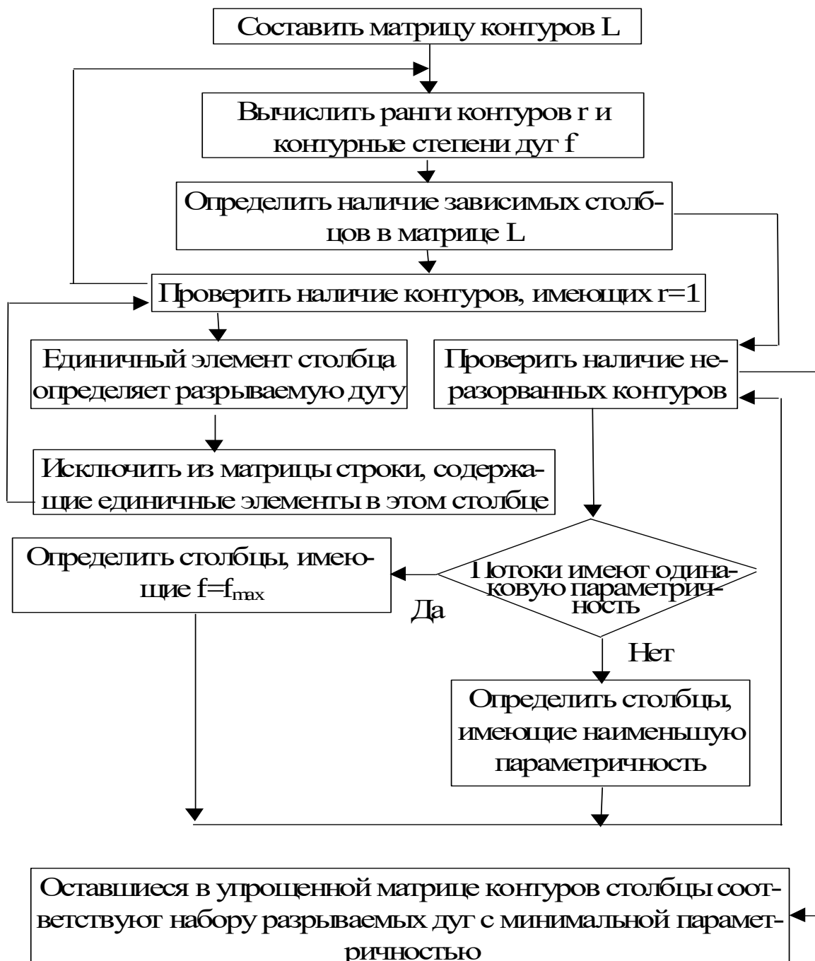
Рис. 4.11. Блок-схема алгоритма определения оптимального множества разрываемых дуг при различной параметричности потоков
