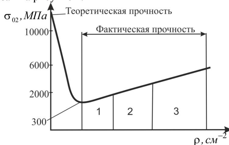
Рисунок 1 – Влияние плотности дислокаций на прочность металла
