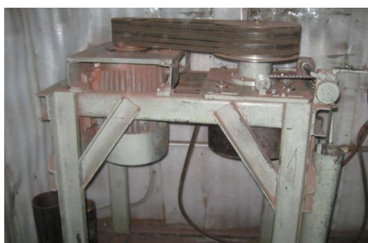
Рис. 1 – Промышленный атритор с емкостью рабочей камеры 15 л, разработанный Чувашским государственным университетом
