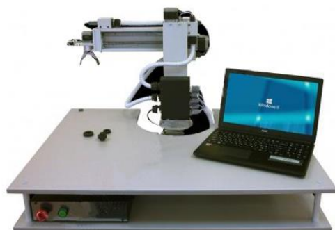
Рис. 1 – Автоматизированный сборочный стенд с компьютерным управлением и техническим зрением (АРС-УР-ТЗ УП-647)
