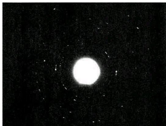
Рис. 8 – Электронограмма с фольги диаметром 3 мм прутка из гранул меди (макродифракция со всего объекта)
