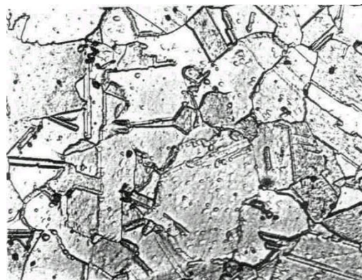
Рис. 3 – Микроструктура прутка из порошка меди (×600)
