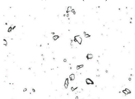
Рис. 10 – Угольная реплика материала прутка из гранул меди (×7500)
