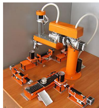
Рис. 2 – Роботизированная сборочная линия с компьютерным управлением транспортно-накопительной системы и техническим зрением (РСТРТЗР УП-153)
