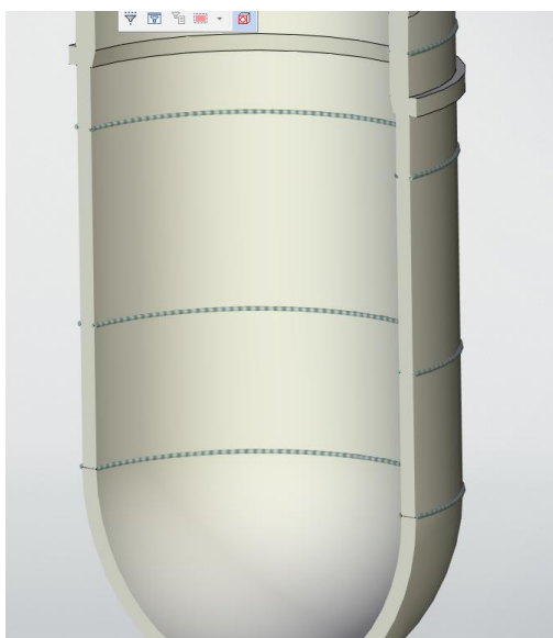
Рис 4. Сварные швы корпуса реактора
