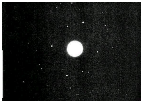
Рис. 5 - Электронограмма с фольги диаметром 3 мм прутка из порошка меди (макроdifракция со всего объекта)
