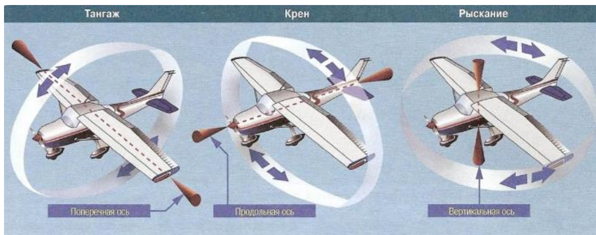
Рис. 2 - Рули управления беспилотника со статическим крылом
