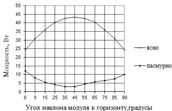
Рис. 2. Изменение мощности модуля RS-250, в зависимости от угла наклона при различной облачности
