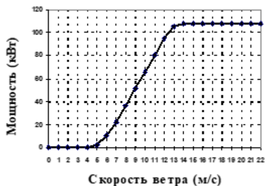
Рис.4. Мощностная характеристика вет-роустановки USW-56-100
