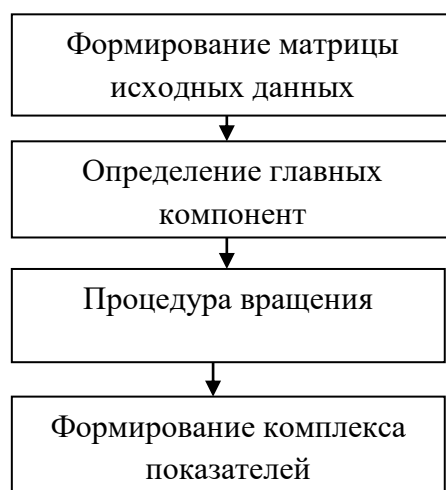
Рис. 4.4 Алгоритм формирования комплекса диагностических показателей с использованием метода главных компонент (сост. авт.)
