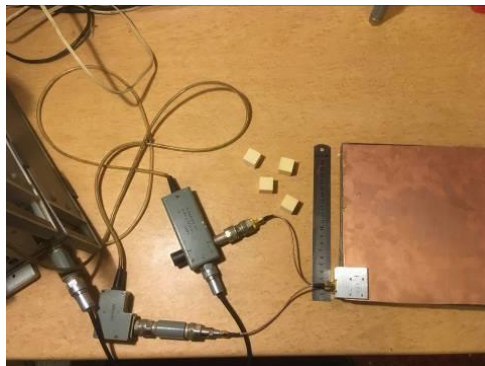
Рис. 7. Подключение микрополосковых структур к измерителю.
