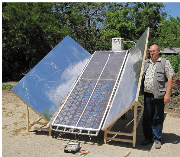
Рис.1. Комбинированная солнечная установка.
