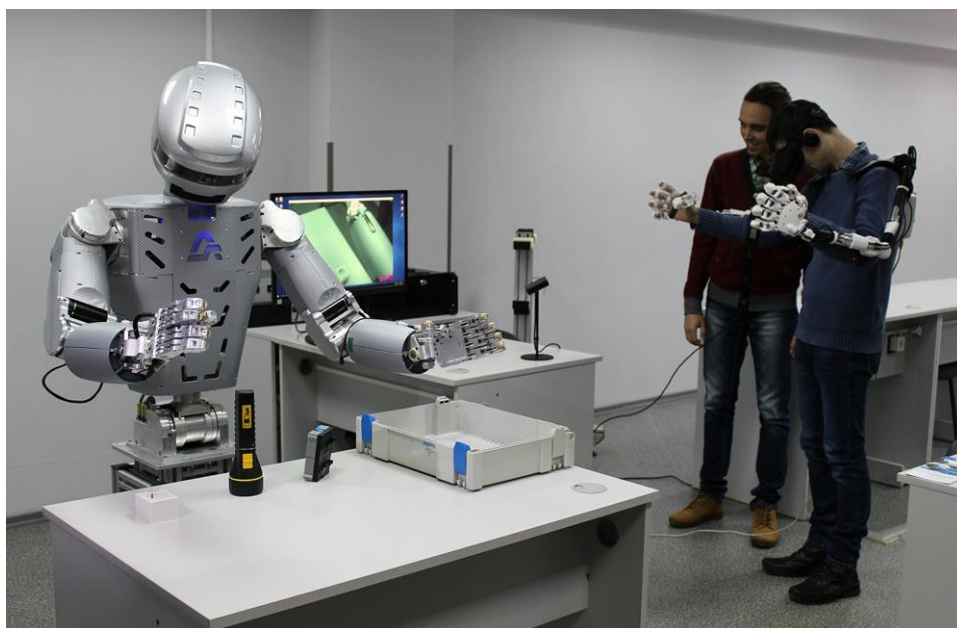
Рис. 1. – Копирующий режим работы комплекса SAR-400
