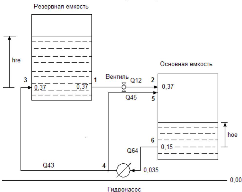
Рис. 4. – Структурная схема сетевой гидросистемы
