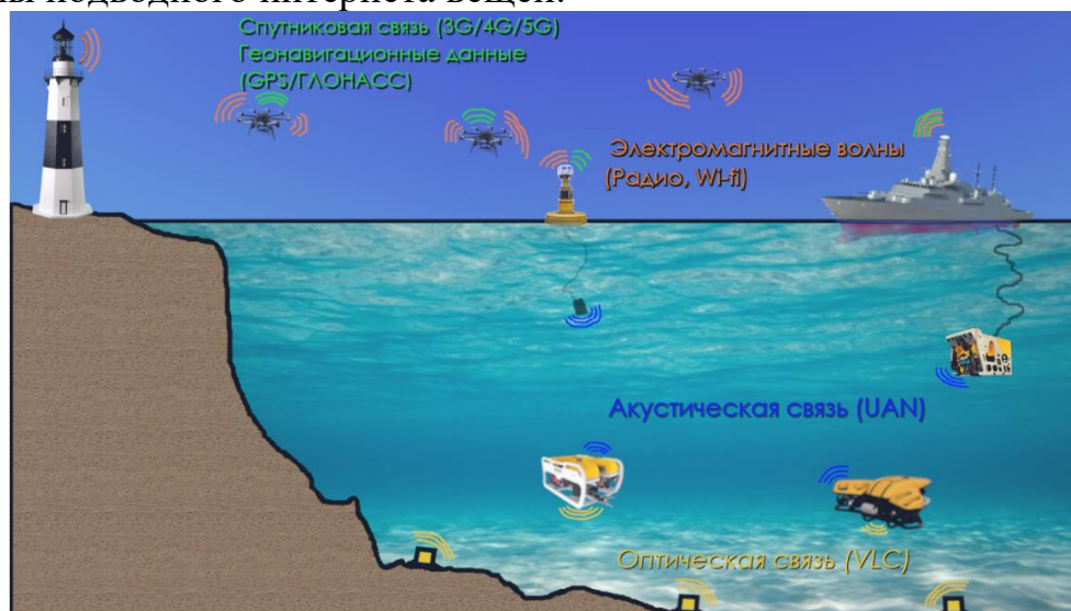
Рис. 1. – Принципиальная схема системы морского интернета вещей
