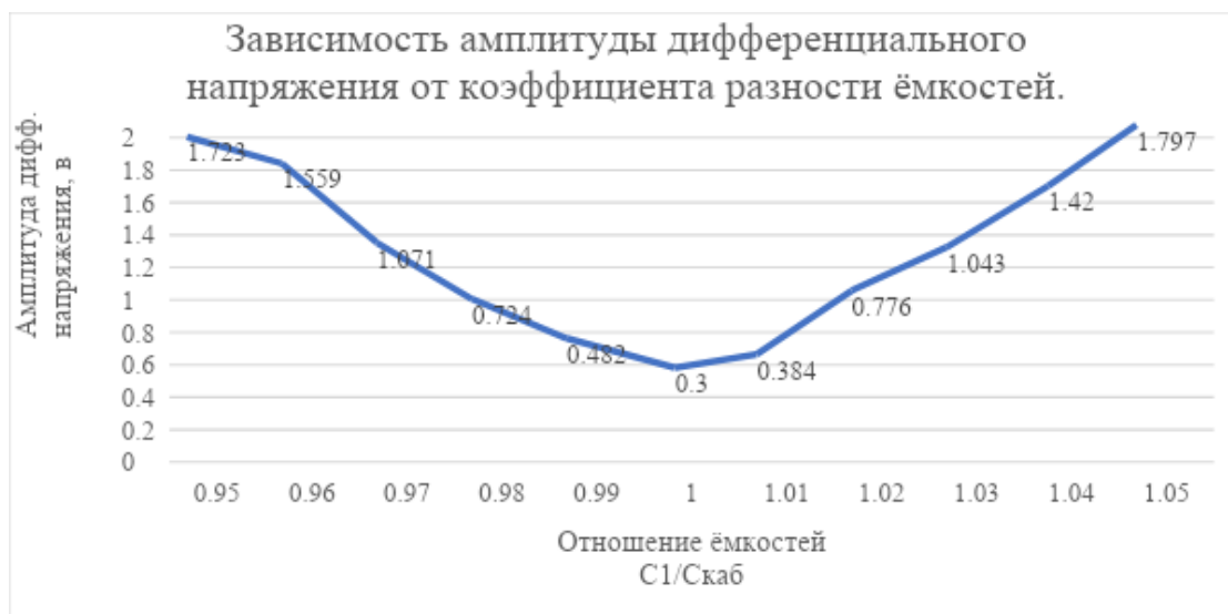
Рис. 7. Зависимость амплитуды дифференциального напряжения от коэффициента разности ёмкостей
