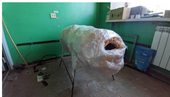
Рис. 5. Покрытие установки слоем полиэтилена.
