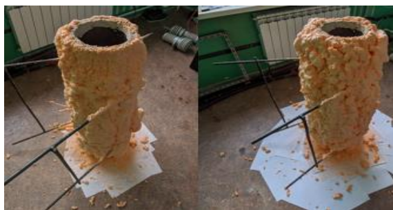
Рис. 3. Нанесение на камеру нагрева двух слоев утеплителя
