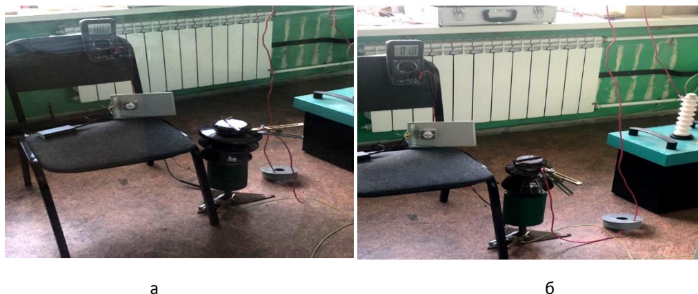
Рис. 3. Экспериментальная схема установки (а – с исправным изолятором, б – с дефектным изолятором)
