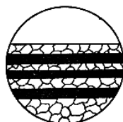
Рис. 16. Схема типичного вида коррозионного разрушения при слоевой коррозии.
