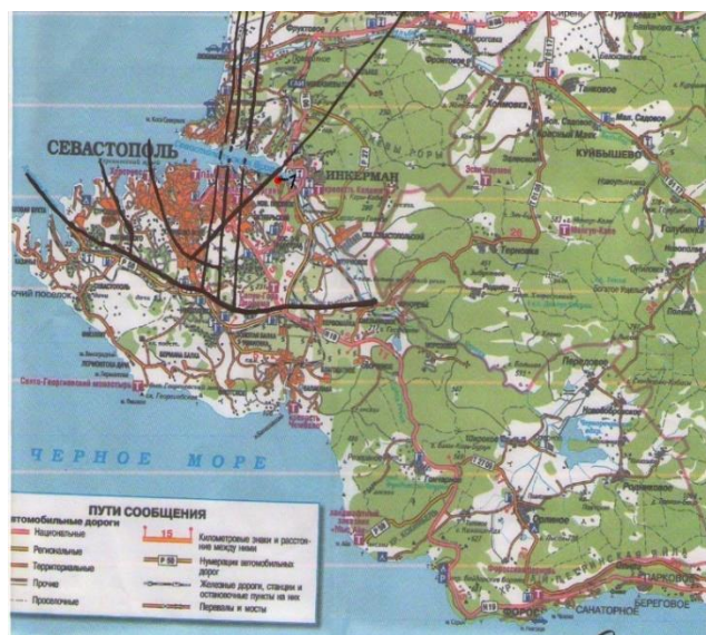
Рис.1. Схема границ потоков подземной геотермальной воды в районе Севастопольского района (сплошные черные линии – потоки подземных термальных вод): 1 – район ГРЭС.
