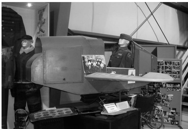
Рисунок 1 – Авиационный тренажер американского изобретателя Эдвина Альберта Линка (кабина Линка или «Линк-тренажер»)
