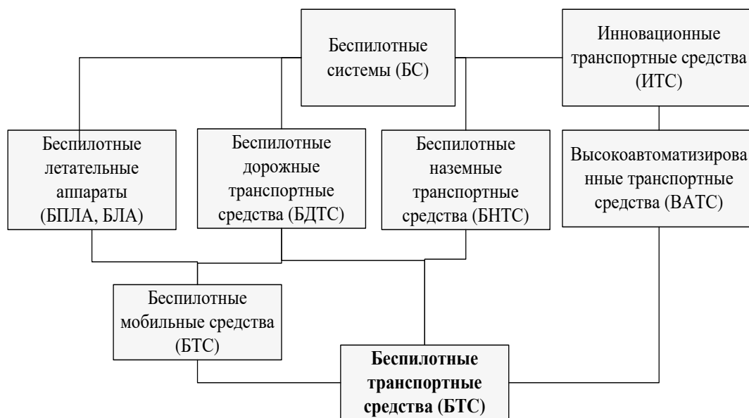
Рис. 1 –Классификация определений беспилотных средств
