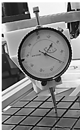
Рис.2 – Исследование повторяемости по оси Z
