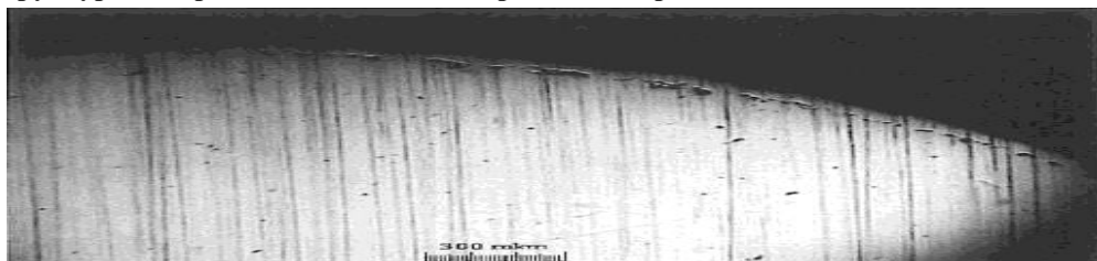
Рисунок 2 - Поперечное сечение с цепочкой пор у цилиндрической поверхности (сталь 316L, нетравлен), x50
