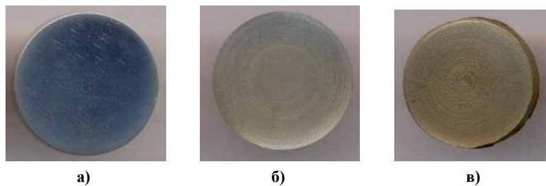
Рисунок 2 - Внешний вид образцов стали 15X11МФ без модификации (а), с азотированием (б) и с структурированной поверхностью с последующим азотированием (в)
