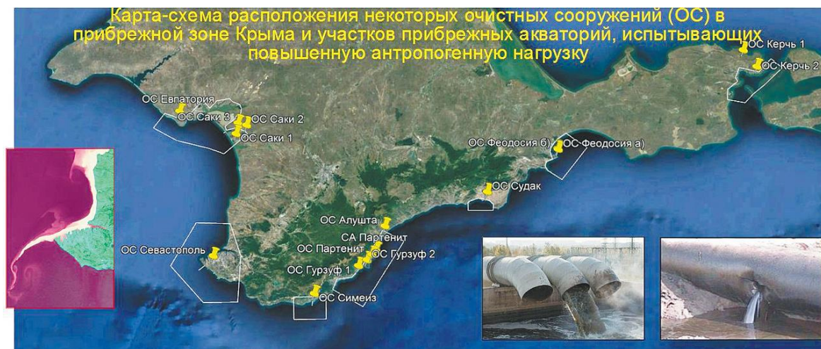
Рисунок 1 – Схема стационарных выпусков загрязненных сточных вод в акваторию моря Севастопольского региона и Крыма
