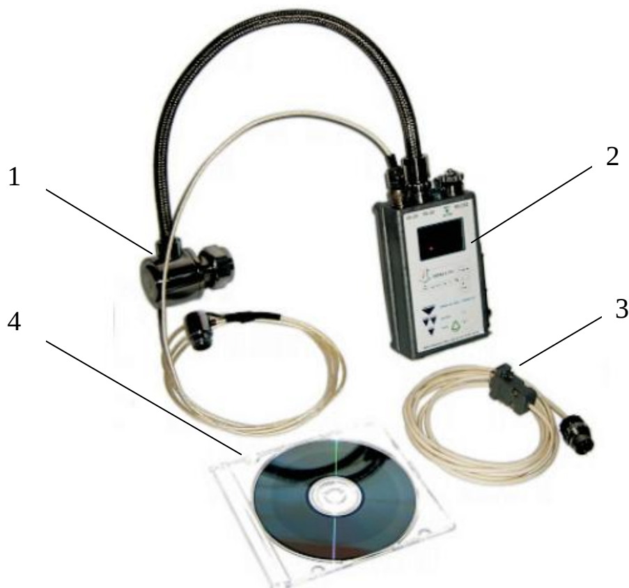
Рисунок 4.8 – Система мониторинга DEPAS: 1 – датчик давления PS-16; 2 – блок контроля DEPAS Handy unit; 3 – кабель; 4 – вибродатчик VS-20
