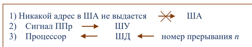
Рисунок Б.9 – Действия ЦП в машинном цикле «Прерывание»
