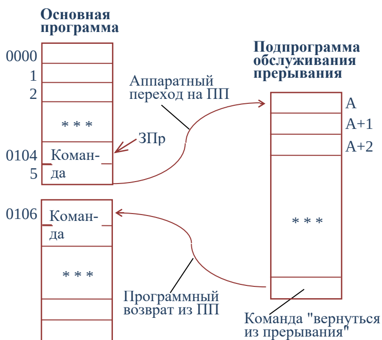
Рисунок 8.3 – Переход на подпрограмму обслуживания прерывания (ПП).
