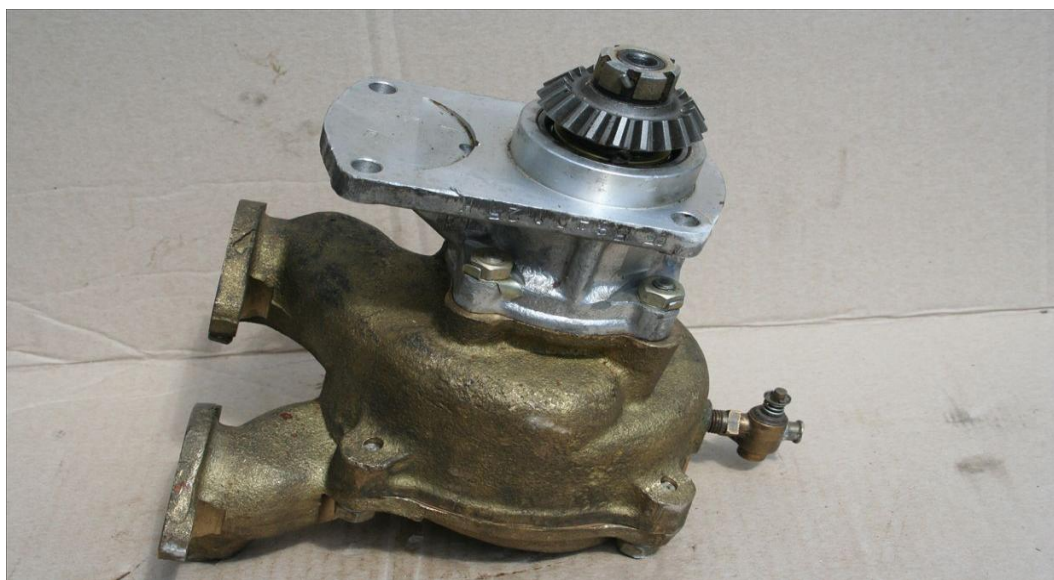
Рис. 5. Насос охлаждающей воды 1BC-3м
