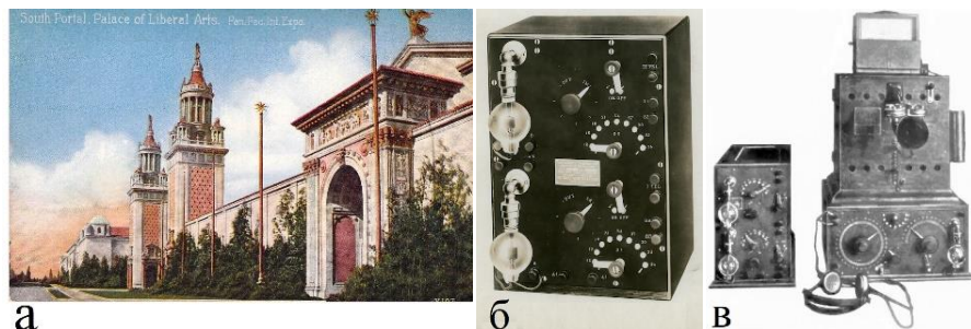
Рис. 16. Панамо-Тихоокеанская Экспо (1915 г.), Дворец свободных искусств (а). Комбинированный детектор DeForest с однокаскадным усилителем стоимостью $200 (б). Аппаратура радиотелефонной связи для железных дорог (в).
