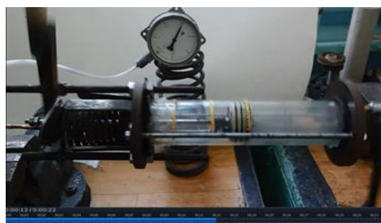
Фото 2. Положение поршня в момент высвобождения пружины. В области перед поршнем наблюдаются изменение цвета воздушной среды.
