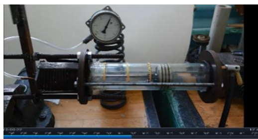
Фото 1. Положение поршня в начале эксперимента.
