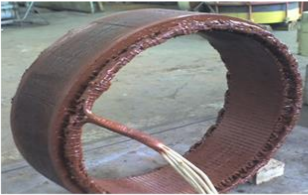
Рис 5. Сердечник в сборестатора СГПМ 20 -125
