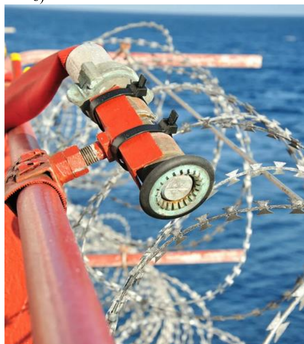
Рис. 3. Использование водяной противопожарной системы (а); колючее ограждение борта (б)
