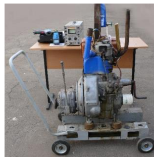
Фото 4. Четырехтактный дизель 1Ч, используемый в эксперименте.
