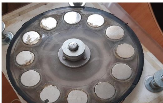
Рис 2. Общий вид ротора с магнитами тороидального аксиального СГПМ
