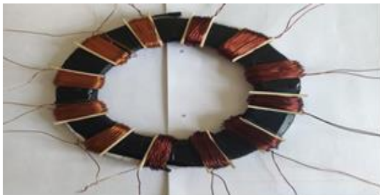
Рис 1. Общий вид готового статора с намотанной фазой из 12 катушек
