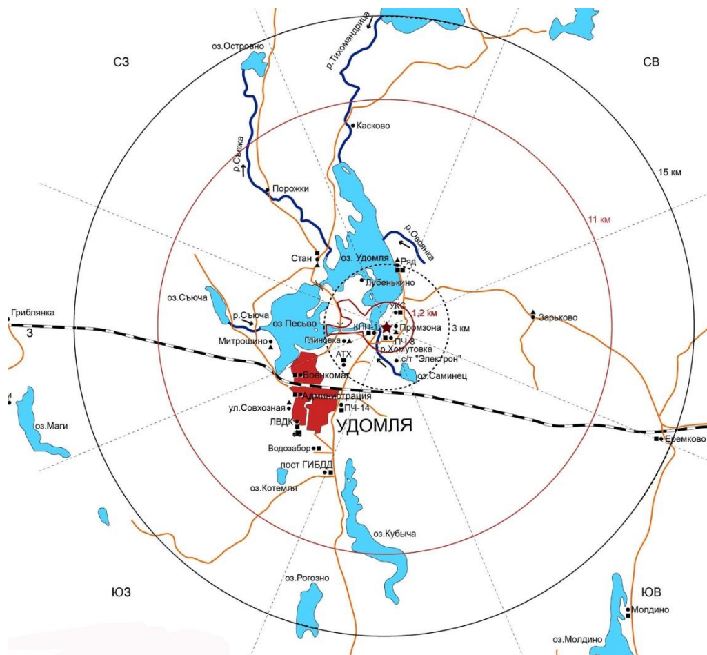
Рис. 2. Схема постов радиационного контроля, санитарно-защитная зона и зона наблюдения Калининской АЭС
