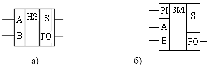
Рисунок 2.5 – Условные графические обозначения неполного (а) и полного (б) сумматоров
