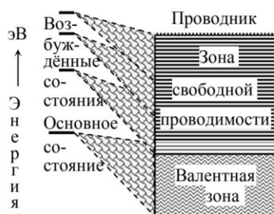
Рисунок 1.3 – Расщепление в проводнике разрешённых энергетических уровней на зоны
