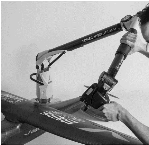
Рис. 4 – работа со сканером закреплённым на КИМ
