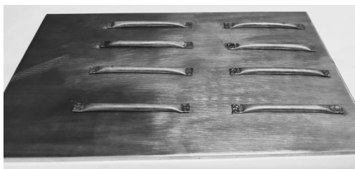
Рис. 1 – Подготовленный образец под наплавку ЭЛУ
