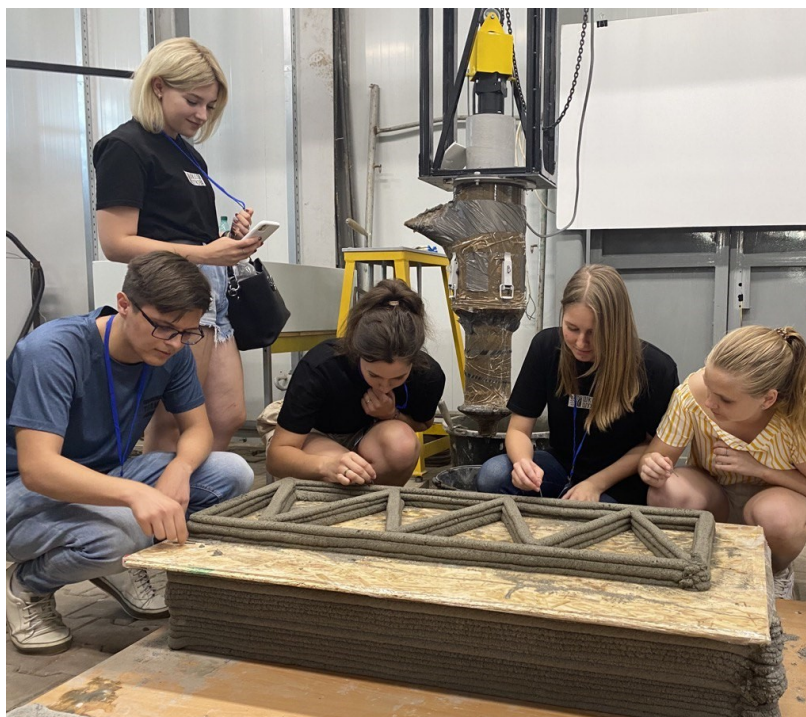
Рис. 4 - Исследование студентами СевГУ свойств перспективных стеновых материалов, полученных с помощью 3D-принтера в лаборатории БГТУ им. В.Г. Шухова (г. Белгород)
