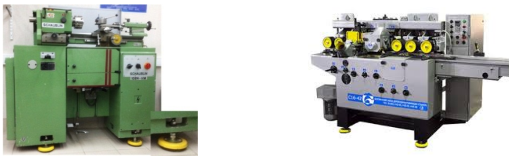
Рисунок 7.4 – Опорный вариант виброизоляции
