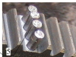
Рисунок 9.5 – Ремонт зубчатых колес наплавкой с установкой шпилек: 1 – медные шаблоны; 2 – шпильки; 3 – фрезерование поломанного зуба; 4 – сверление отверстий под резьбу; 5 – нарезание резьбы и вкручивание шпилек; 6 – заварка шпилек
