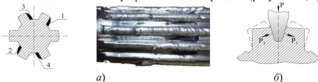
Рисунок 9.8 – Способы восстановления шлицев: а – наплавкой; б – раздачей
