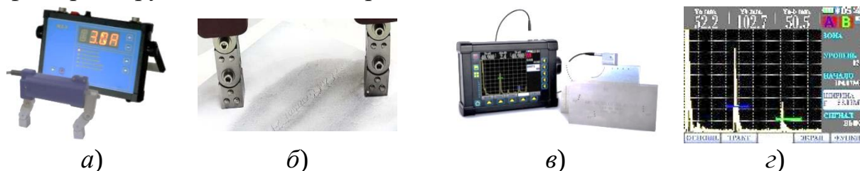
Рисунок 8.1 – Магнитопорошковая дефектовка: а – магнитопорошковый дефектоскоп мод. МД-М; б – осадок магнитного порошка на трещинах
