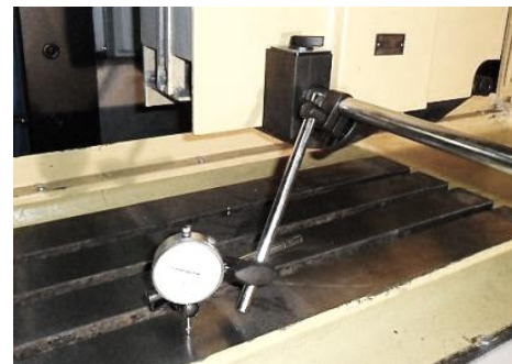
Рисунок 12.3 – Контроль геометрической точности: а – радиальное биение шпинделя фрезерного станка; б – проверка точности ходовых винтов станка с ЧПУ; в – проверка перпендикулярности шпинделя фрезерного станка; г – числа оборотов шпинделя токарного станка тахометром; д – проверка осей станка с ЧПУ; е – проверка столов расточного и шлифовального станков
