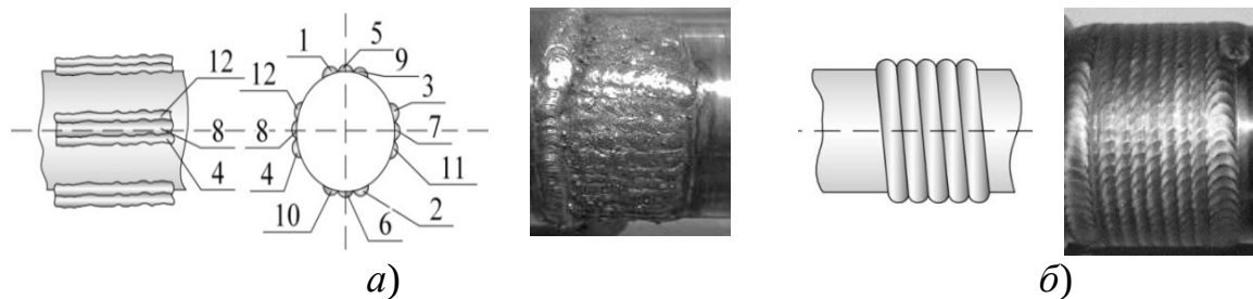
Рисунок 9.2 – Наплавка валов: а – по образующей; б – спиралью
