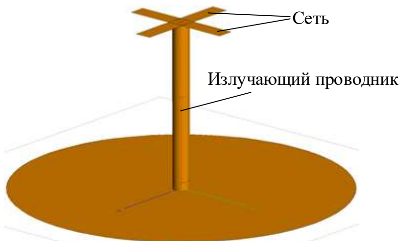
Рис. 2.12 — Модель несимметричного вибратора с использованием примитива Cylinder
