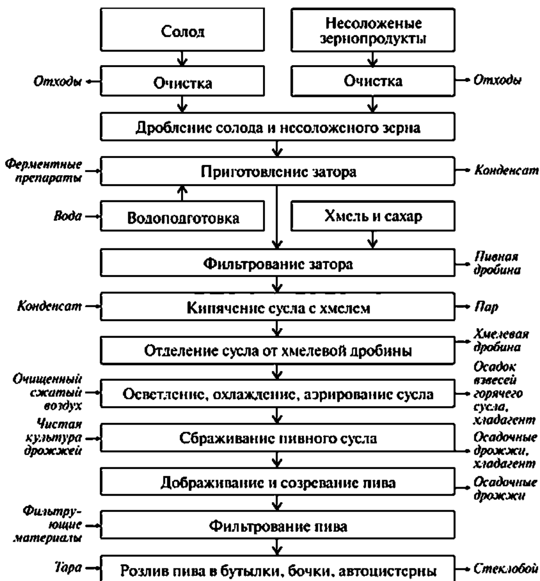
Рис. 9.1. Технологическая схема производства пива
