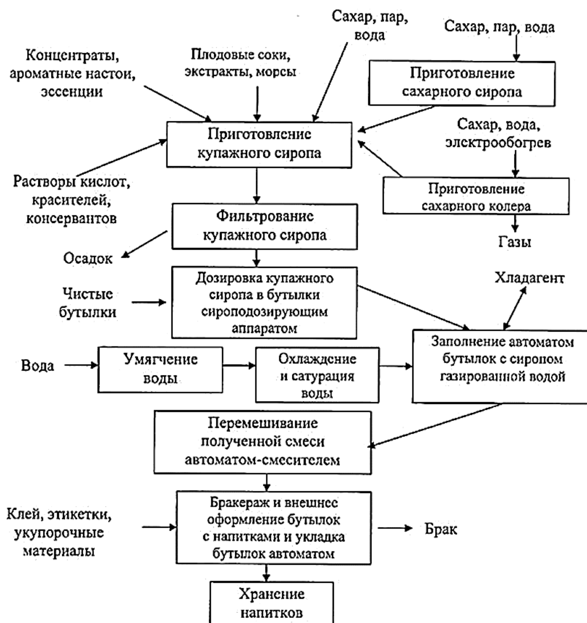
Рис. 10.1. Технологическая схема получения газированных напитков
