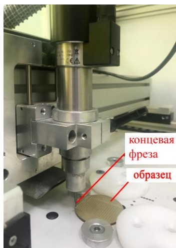
Рисунок 4. Фотография сверлильно-фрезерного станка с ЧПУ «Bungard CCD/ATC
