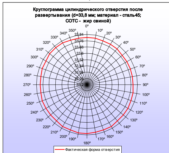
Рисунок 3. Отклонение от круглости цилиндрического отверстия: а) после развертывания с СОТС – масло минеральное И-20; б) после развертывания с СОТС – масло подсолнечное; в) после развертывания с СОТС – жир свиной
