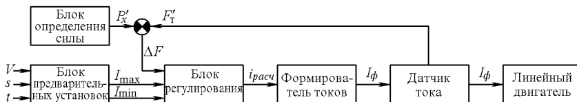
Рисунок 3 - Функциональная схема устройства компенсации P_x
