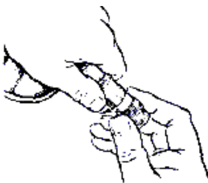
Рис. 9. Освобождение барабана микрометра
