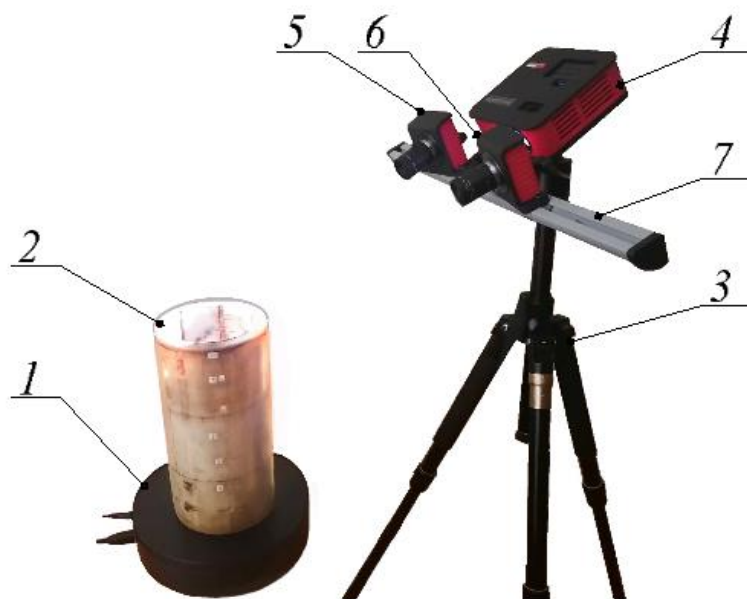
Рисунок 1 – Схема сканирования поверхности износа дейдвудного подшипника
