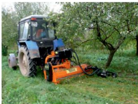
Уход за залуженными междурядьями мульчером с автоматизированной секцией
