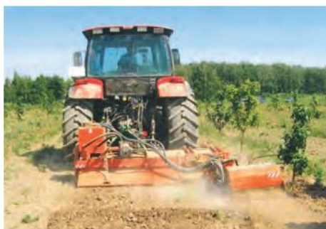
Обработка почвы в междурядьях фрезой с автоматизированной секцией
